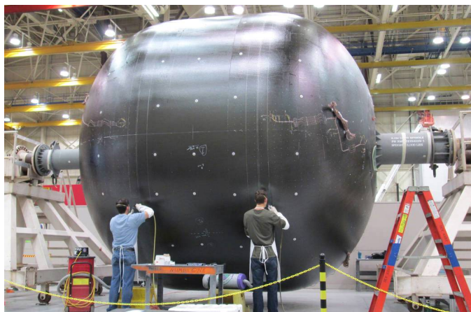
Figura 1. Criotanque de propelente de hidrógeno, de 5.5m de diámetro, realizado en composites (fuente: NASA / Boeing)
